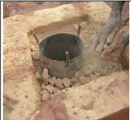
Les restes de briques taillées sont grossièrement concassés, puis servent à remplir le haut du cuiseur. On peut également utiliser de la terre. On arrête le remplissage à 5 à 7 cm du haut des briques.
